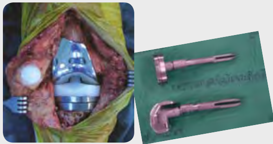
รูปที่ 6 (6.1 และ 6.2) revision total knee system สเต็มทำจากไทเทเนียม มี slot และ spline ที่ปลายสเต็ม เพื่อให้มี interference fit และเพิ่ม rotational stability มี offset ให้เลือกตั้งแต่ 2 ถึง 6 มิลลิเมตร ทำให้สามารถวาง implant ได้ในตำแหน่งที่เหมาะสมที่สุด
